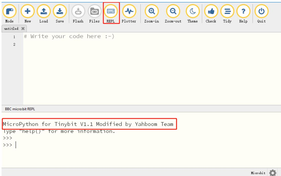
4. 代码编写完成后,请点击‘Flash’按钮,将程序下载到 microbit 主板上。
